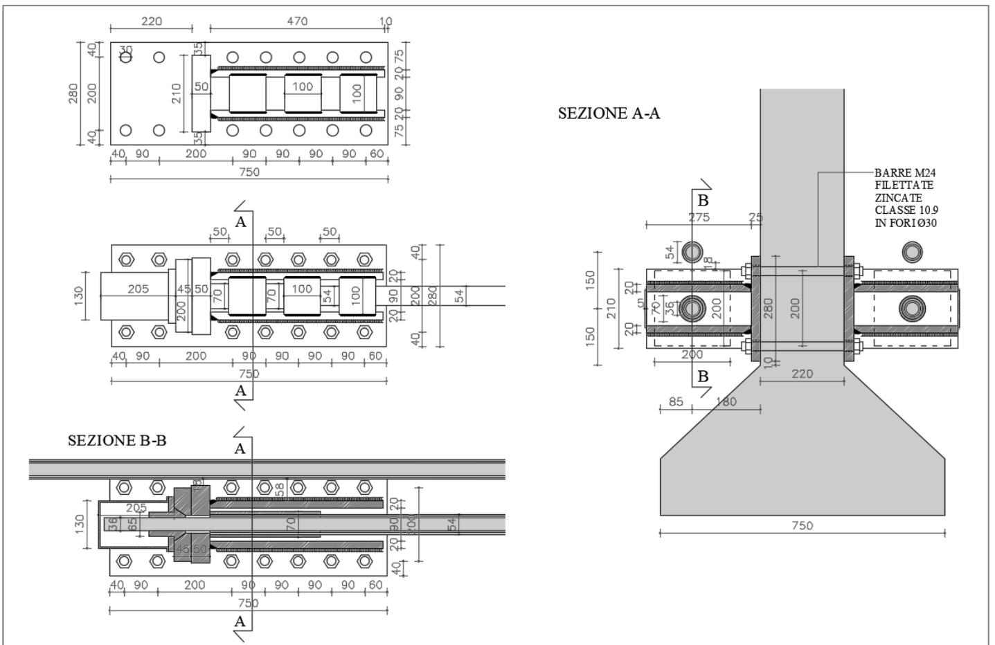
Figure 8. External prestressing bars' anchorage / Ancoraggio della barra di precompressione esterna.
