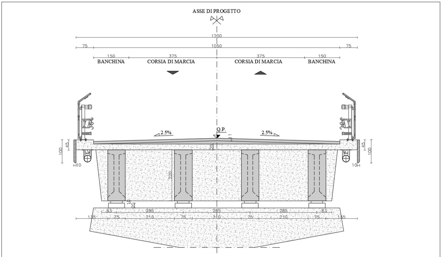
Figure 2. Bridge deck: cross section at pier / Impalcato: sezione trasversale in asse pila.
