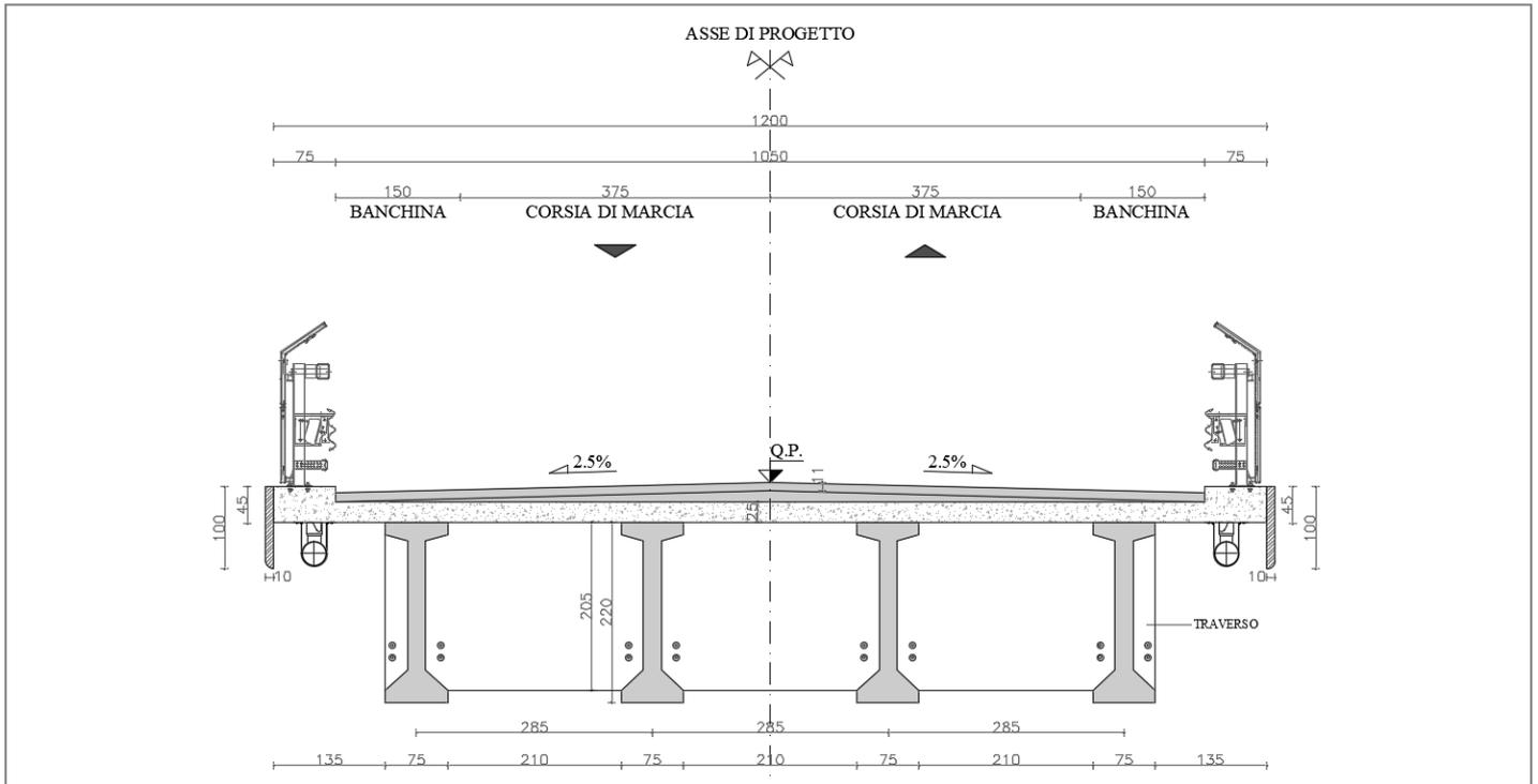
Figure 1. Bridge deck: cross section at mid span / Impalcato: sezione trasversale in campata.
