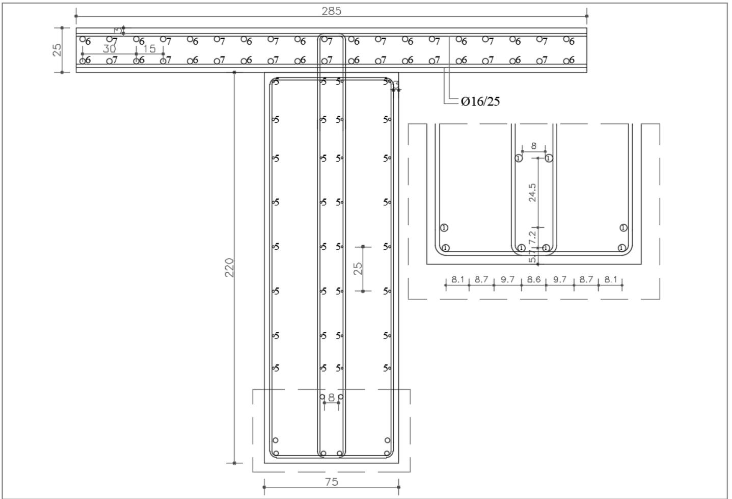
Figure 7. Girders: section E-E / Trave: sezione E-E.
