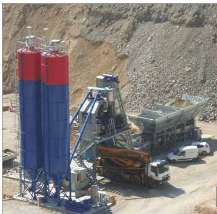
Euromobil FAST 100: impianto mobile dalle prestazioni elevate. Facile da trasportare e rapido da installare, non richiede opere di fondazione.
