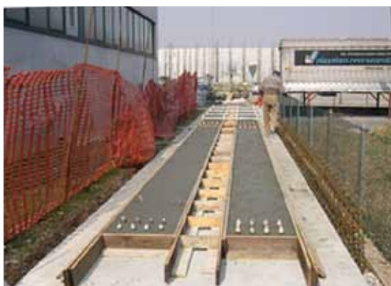
Fig. 10 - Lastre (lunghe 8 m, larghe 40 cm e spesse 6 cm) bloccate alle estremità e lasciate all'aria esposte al ritiro igrometrico contrastato
