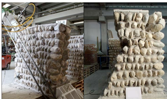
Figura 11. Campione non rinforzato in muratura di ciottoli: a sinistra durante l'esecuzione della prova, a destra dopo la rimozione del carico applicato.
