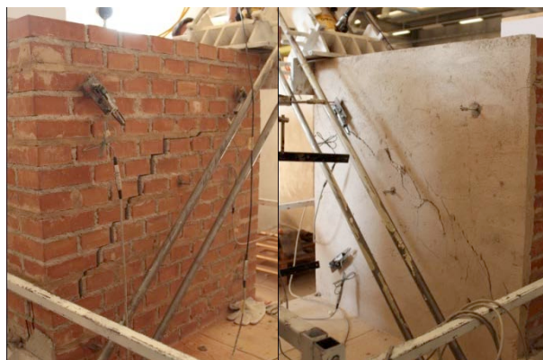
Figura 13. campione in muratura di laterizi con rinforzo ibrido.
