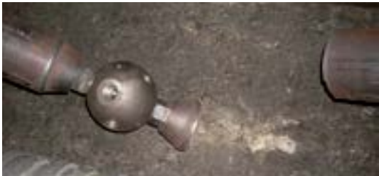
Fig. 29 - Esecuzione della prova di trazione su un nodo in laboratorio
