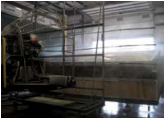
Fig. 28 - Apparecchiatura di prova per il test dinamico di penetrazione dell'acqua sul cuscino ETFE
