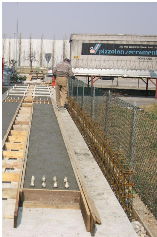
Fig. 1 – Prove di campo sul ritiro contrastato in lastre appoggiate su terreno e bloccate alle estremità.
