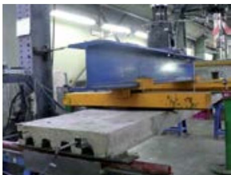
Fig. 4 - Sperimentazione su lamiere grecate per solai collaboranti (Politecnico di Milano)
