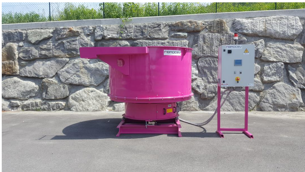
Figura 2. Impianto dosatore di fibre automatico ( conforme a Industria 4.0 )
