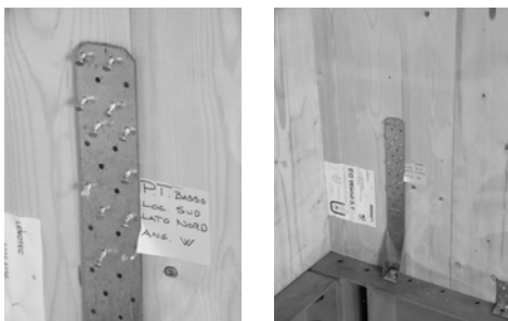
Figura 13. Collasso di Hold-down dopo Nocera Umbra 1,2g
