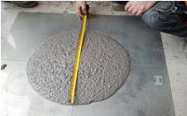
Figura 3. Slump – Flow (UNI EN 12350-8) su calcestruzzo geopolimerico
