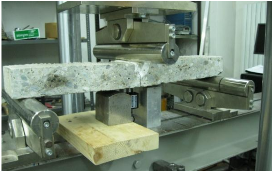
Figura 2: set-up prova di flessione su tre punti
