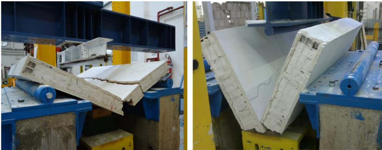
Figura 5. Campioni non Rinforzati dopo la prova
