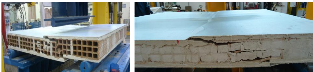
Figura 6. Campioni Rinforzati dopo la prova
